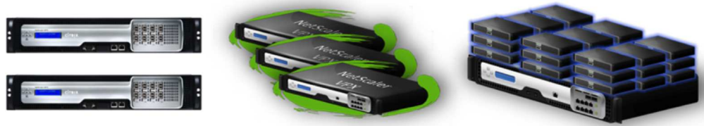
図1 デバイスの選択肢 – テナント1専用のNetScaler MPX HAペアとテナント2専用のNetScaler MPX クラスタ、テナント3~NはNetScaler SDXを共用
