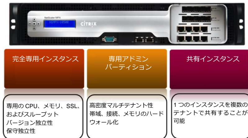
図 5 NetScaler インスタンスとアドミンパーティションの分離度の特徴
